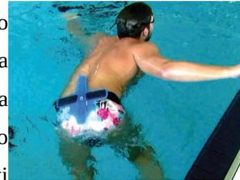
**IL TEACH-TOC:** Consiste in un cilindro con una sfera d'acciaio al suo interno, applicato alla vita del nuotatore con una cintura. Se il nuotatore esegue un adeguato rollio, percepisce un feedback sonoro dalla sfera che urta sul fondo del cilindro.
